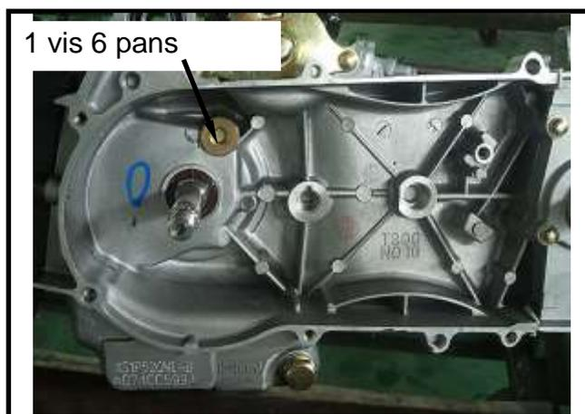
Placer le côté gauche du variateur vers le haut, puis mettre en place l'outil de dépose/pose de variateur sur le variateur. Engager la vis de l'outil de dépose/pose de variateur dans le variateur, puis séparer les parties gauche et droite du carter. Déposer la chaîne de distribution.
