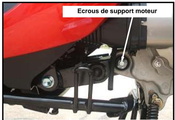
Contrôler l'état du support moteur, de la bague d'amortisseur arrière et de la butée caoutchouc. Les remplacer si besoin.
