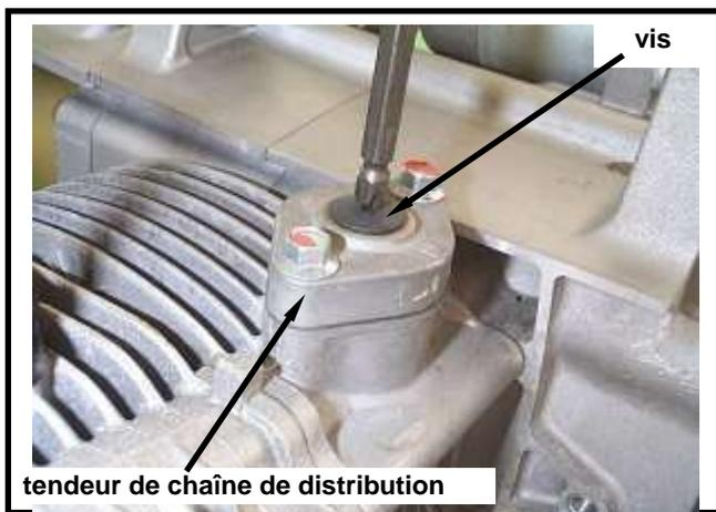
Tourner le volant moteur dans le sens inverse des aiguilles d'une montre à l'aide d'une clé en T jusqu'à ce que le repère "T" sur le volant moteur s'aligne avec le repère sur le carter de manière à ce que l'orifice sur le pignon d'arbre à cames soit orienté vers le haut et le piston soit au PMH.
