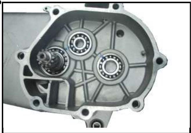
Mettre en place un roulement d'arbre d'entraînement neuf dans le carter gauche.
