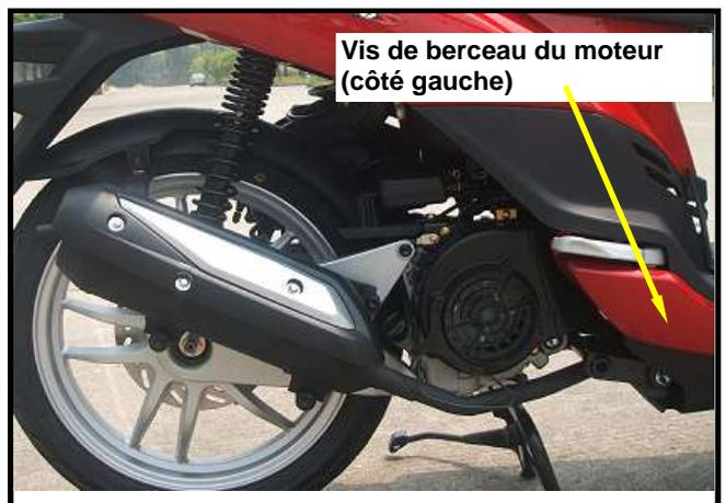
Contrôler l'état de la butée caoutchouc et de la bague du berceau du moteur. Les remplacer si besoin.
