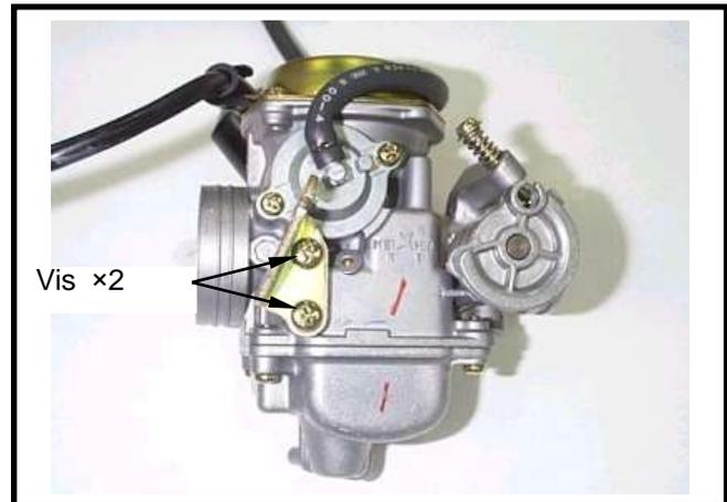
Déposer les vis (vis x 2) de la valve de coupure d'air et son couvercle.
