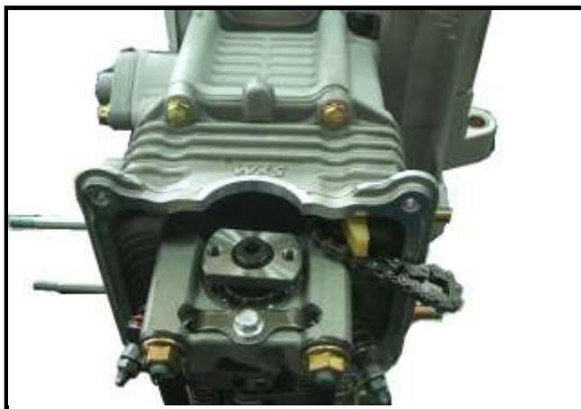
Déposer les 2 vis de fixation de culasse du couvercle latéral gauche de culasse.
