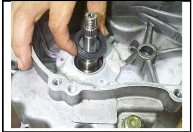
Emmancher l'arrêt d'huile dans la position spécifiée avec l'outil de pose d'arrêt d'huile (19,8x30x5).
