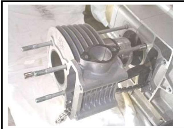
Déposer le joint de cylindre et les pions de positionnement.
