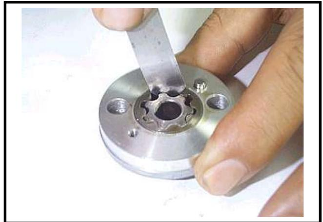
Vérifier le jeu entre le flanc du rotor et le corps de pompe.
