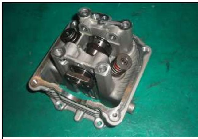
Après dépose des clavettes de soupape, relâcher le lève-soupapes puis dégager la cuvette de ressort, le ressort de soupape et les soupapes.
