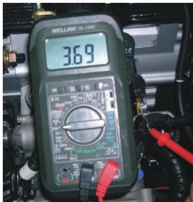
Tension de sortie TPS - papillon totalement ouvert
