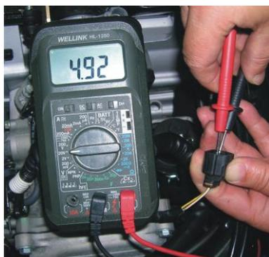
Mesure de la tension de fonctionnement
