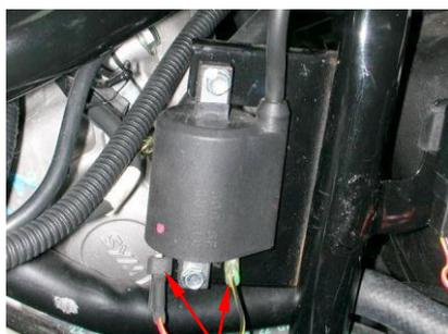
Mesure de la résistance de la bobine du premier circuit
