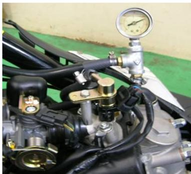
Mesure de la pression dans le circuit d'alimentation
