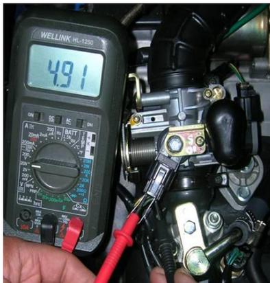
Mesure de la tension de fonctionnement
