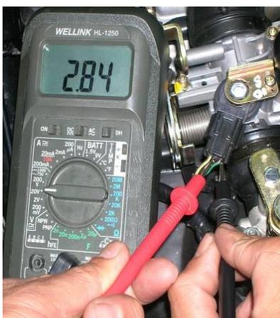
Câbles de mesure de la tension de sortie, en pleine
